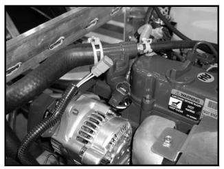
Figure 11b-17 Thermostat Switch
